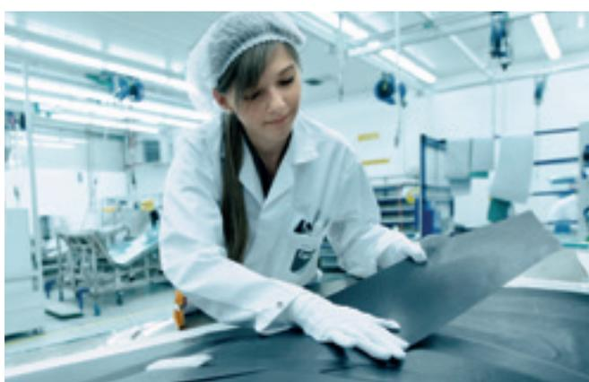
*Im Cleanraum wird die Außenstruktur händisch aufgelegt.*
