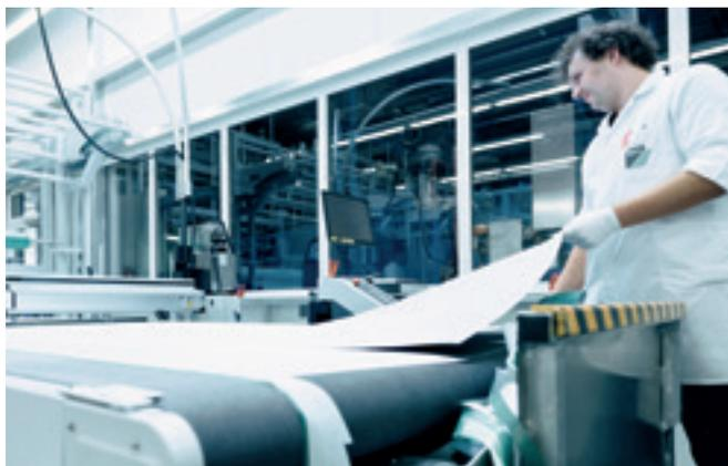
*Vor der weiteren Verarbeitung werden die Carbonmatten präzise zugeschnitten.*
