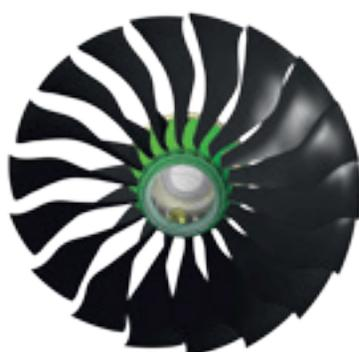
Fan (Motorgebläse) mit Fan Blades (Turbinenschaufel) und dazwischenliegenden Annulus Fillers
